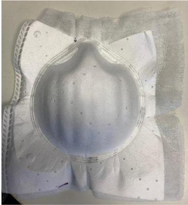
Die FFP-Masken werden nach dem Tiefziehen mit Ultraschall an den Rändern verschweißt.
